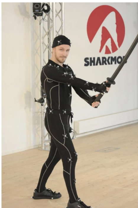
Abb. 2: Motion Capture Suit der Firma Vicon
