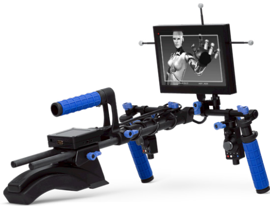
Abb.6:Marker basiertes Tracking System für eine Virtuelle Kamera
