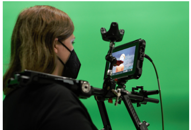
Abb.7:Sensor basiertes Tracking System für eine Virtuelle Kamera, basierend auf einem Sensor von einem VR-System
