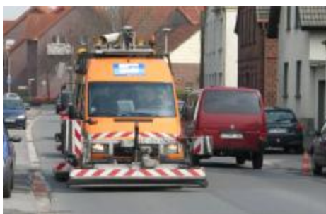
Messtechnische Erfassung des Straßenzustands
